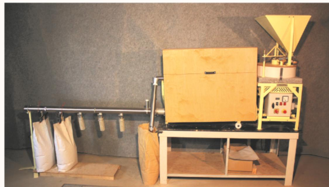
**Moulin présenté avec le coffret électrique optionnel et le tube d'ensachage tout inox**
